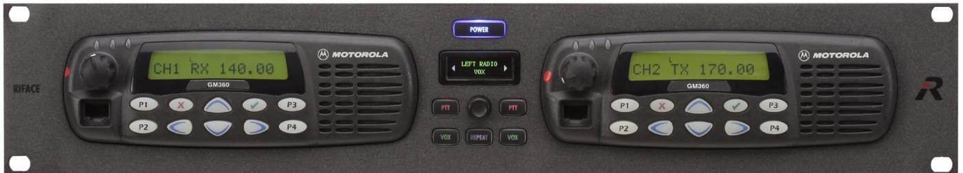
Das RiFace ist ein universell einsetzbares Funk-Interface. 1992 erstmals vorgestellt, hat sich das RiFace als Standard zur Verbindung drahtgebundener Kommunikationsanlagen mit Funkssystemen etabliert.
